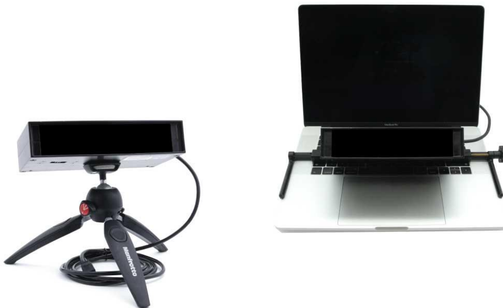
Figura 9. Hardware de Eye-tracking: À esquerda o Eye-Link Portable Duo e à direita o setup utilizado na experiência, https://www.sr-research.com/eyelink-portable-duo
